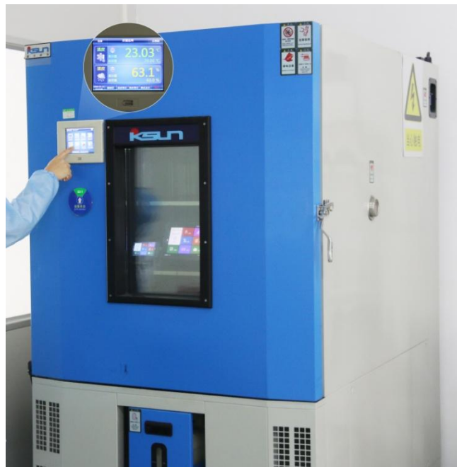
图 6-7 高低温老化测试图
